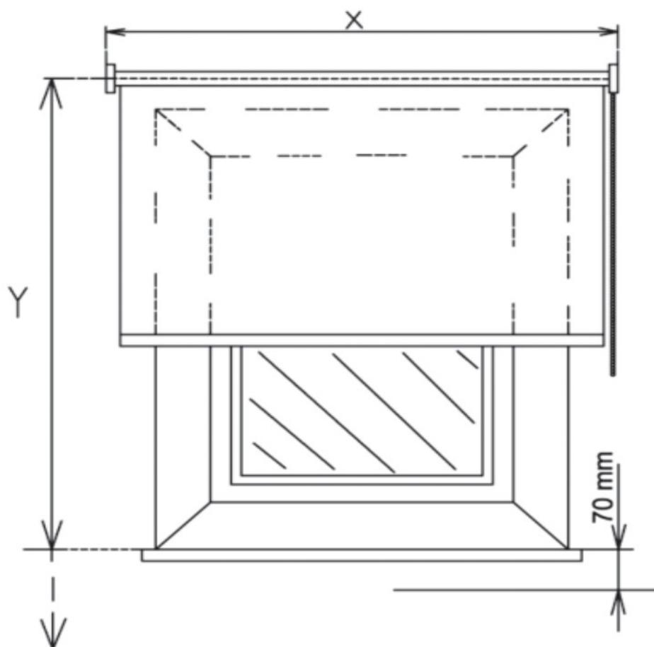
**X = šířka otvoru + přesah min. 400 mm na každé straně šířky**
